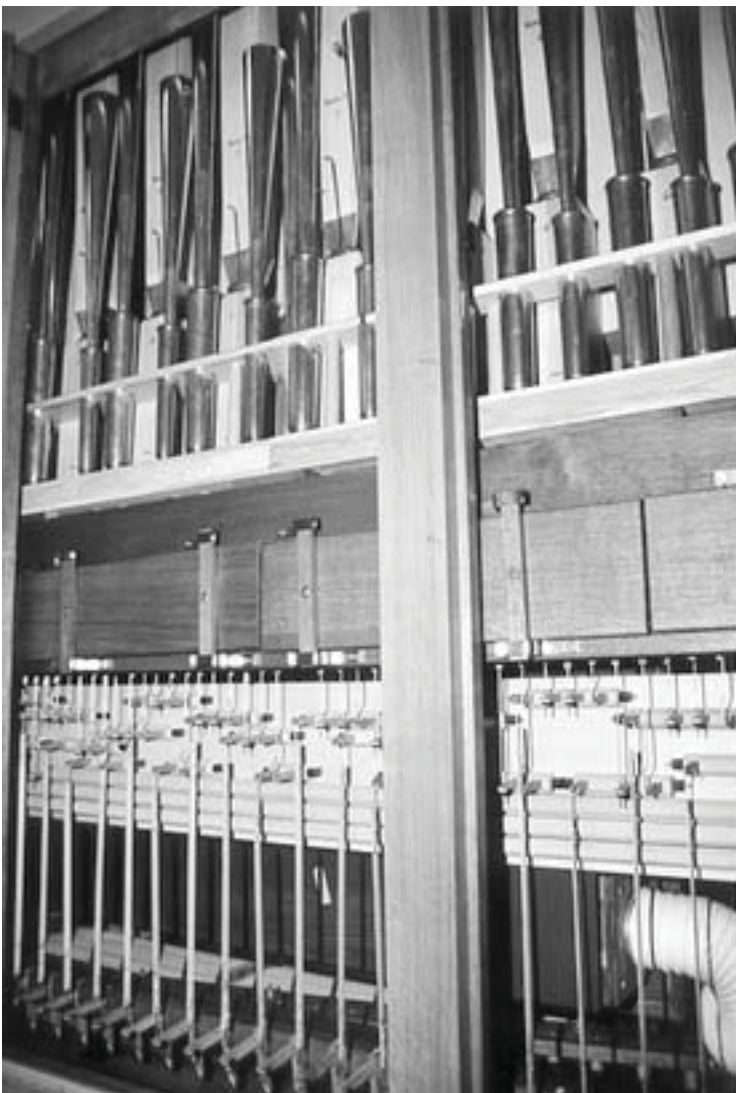
La face arrière (ouverte) du corps de Pédale
